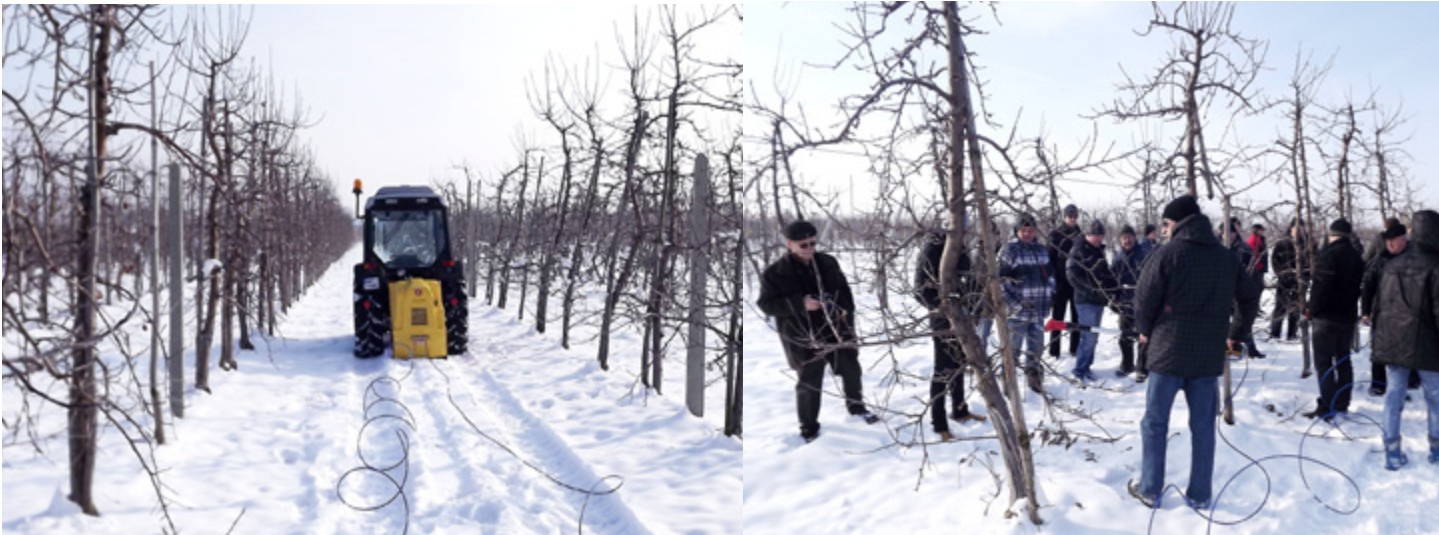
Fot. 4, 5. Pokaz pracy sekatorów pneumatycznych, po lewej wydajna sprężarka mocowana na TUZ ciągnika i napędzana WOM, po prawej prezentacja możliwości sekatorów pneumatycznych
